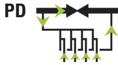
Para aplicaciones en las que hay suficiente diferencia de presión en la línea principal entre la presión de la fuente y la presión requerida aguas abajo del FERTIKIT.
