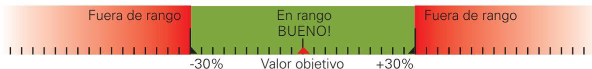
Con el controlador configurado para operar de acuerdo a los valores de EC/pH - si los valores de EC y pH medidos en el cubo están dentro de un rango de  $\pm 30\%$  de desviación de los valores objetivo, el sistema podrá corregirlos automáticamente.
