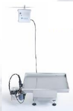
Sistema para cultivos en bolsas o macetas, 50*45 cm y soporte de 50 kg con bascula de piso
